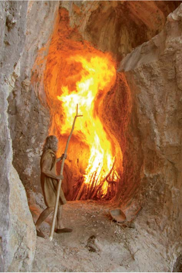
Abb. 4) Erzabbau durch Feuersetzung (Foto H. P. Schrattenthaler)
